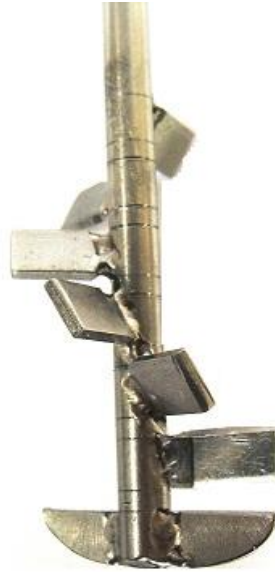
Figure V-1. Géométrie 1: Agitateur hélicoïdal à plusieurs pales.
