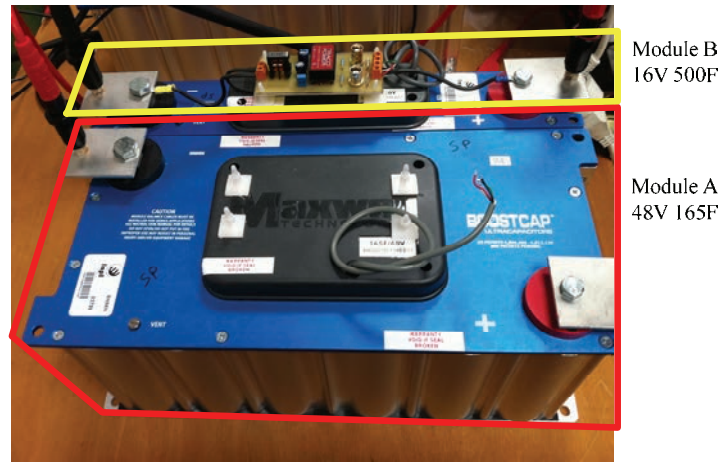
Figure 3-33. Banc de supercapacités utilisé en moyenne tension.
