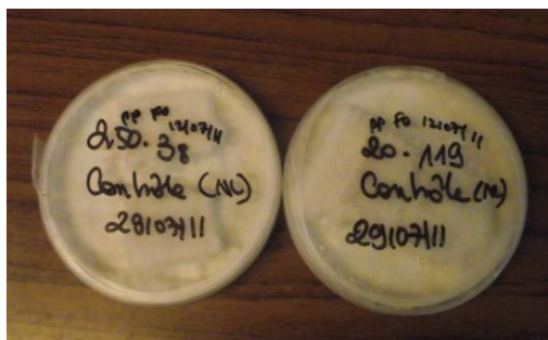
Figure 29 : Aspect des éprouvettes témoins à la fin des 16 semaines d'exposition au Poria Placenta cultivé en boîte de pétri
