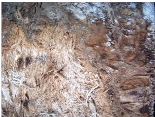
Figure 14 : Pourriture blanche provoquée par le Coriolus versicolor
