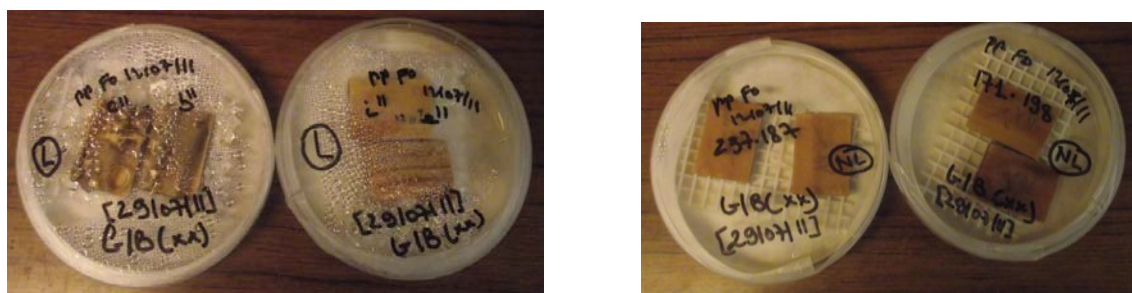
Figure 33 : Aspect des éprouvettes traitées au Gel (issu du GlycérolC 14 ) / borax, lessivées (à gauche) ou non (à droite), à la fin des 16 semaines d'exposition au Poria Placenta cultivé en boîte de pétri
