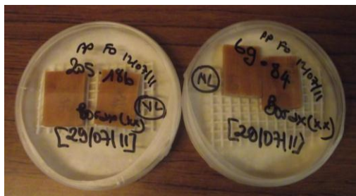
Figure 31 : Aspect des éprouvettes traitées au borax, non lessivées, à la fin des 16 semaines d'exposition au Poria Placenta cultivé en boîte de pétri
