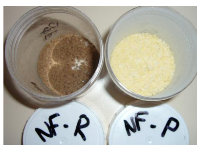
Figure 36. Perméat (NF-P) et rétentat (NF-R) issus du fractionnement de l'EXL par nanofiltration membranaire après 8 diafiltrations et lyophilisation.
