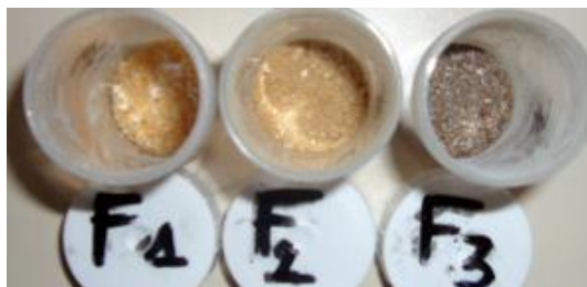
Figure 37. Fractions A.1 (F1), A.2 (F2) et A.3 (F3) issues du fractionnement de l'EXL nanofiltré par chromatographie liquide d'échange d'anions.
