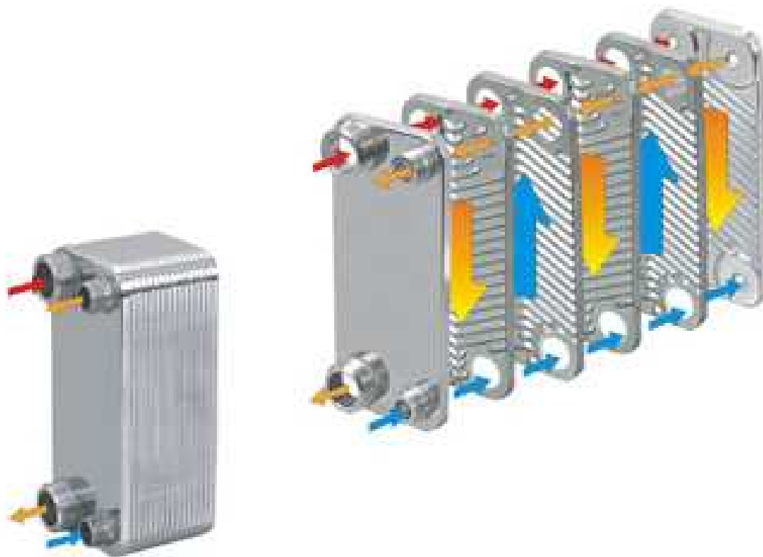
Fig. 4.3. Schimbător de căldură cu plăci [32]
