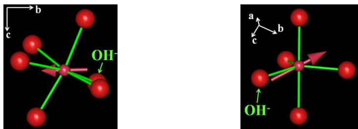
Figure 4.25. Orientations des moments magnétiques par rapport à leur environnement chimique : site Co1 (gauche) ; site Co2 en coordination 5 (droite).
