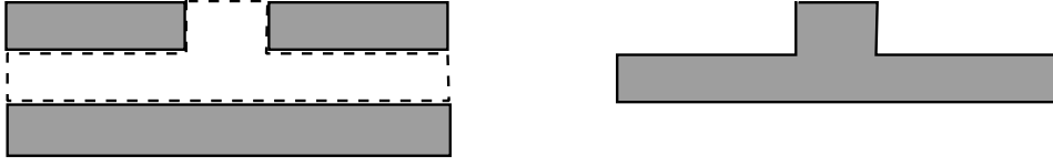
FIGURE 3.31 – Application du principe de Babinet pour étudier un relief sortant rectangulaire.
