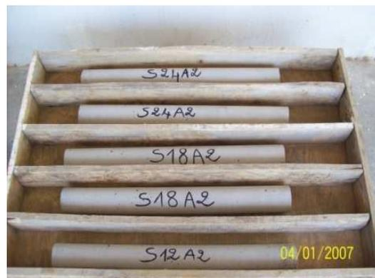
Fig. 5.26 : Conservation des éprouvettes à l'air ambiant
