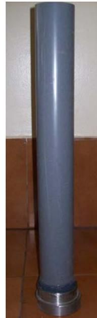
Fig. 5.18 : Fixation de l'éprouvette au fond
