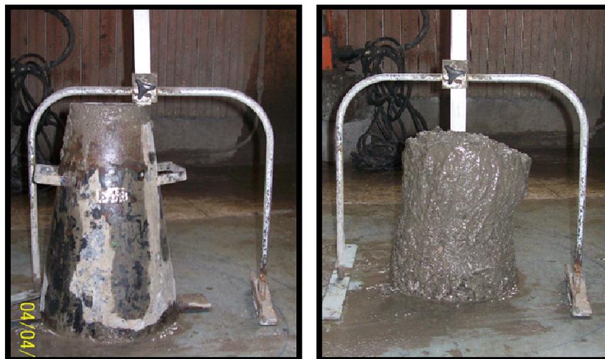
Fig. 4.26: Exemple de mesure d'affaissement au cône d'Abrams
