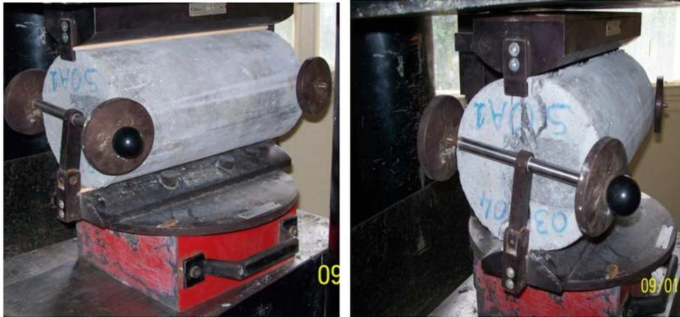
Fig. 5.13 : Résistance à la traction par fendage
