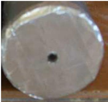
Fig. 5.22 : Fermeture de l'extrémité de l'éprouvette par un film d'aluminium adhésif
