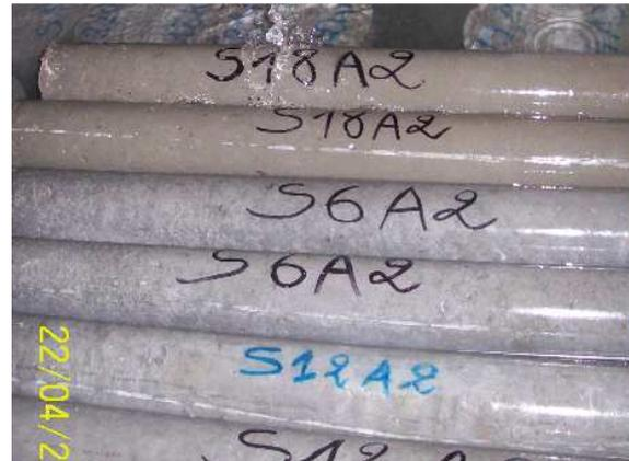
Fig. 5.25 : Conservation des éprouvettes dans l'eau
