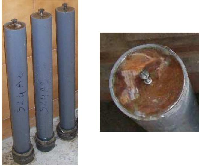
Fig. 5.21 : Eprouvettes après coulage
