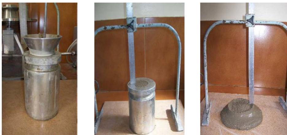
Fig. 4. 20 : Mesure de l'affaissement d'un MBE
