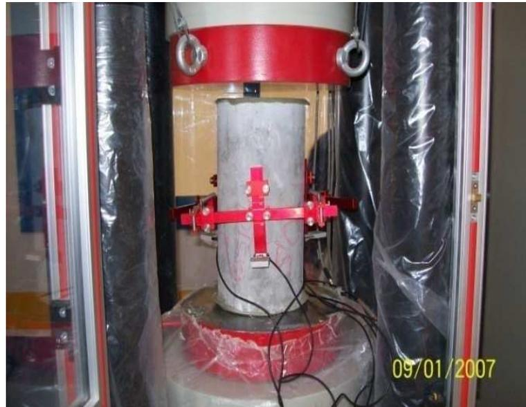
Fig. 5.9 : Presse de compression pour éprouvettes 16 x 32 cm.
