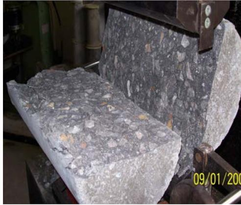
Fig. 5.16 : Exemple d'un plan de rupture en fendage d'un béton courant
