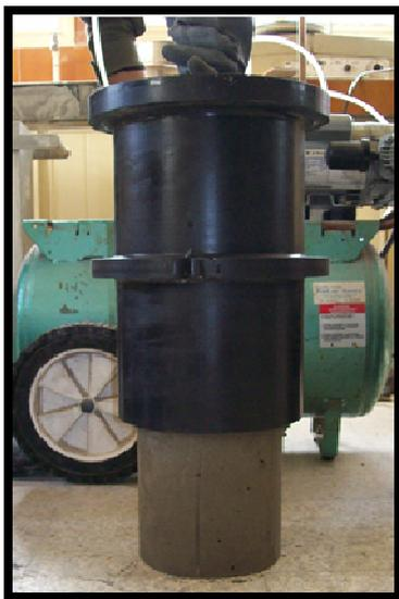
Fig. 4.28. Démoulage des éprouvettes
