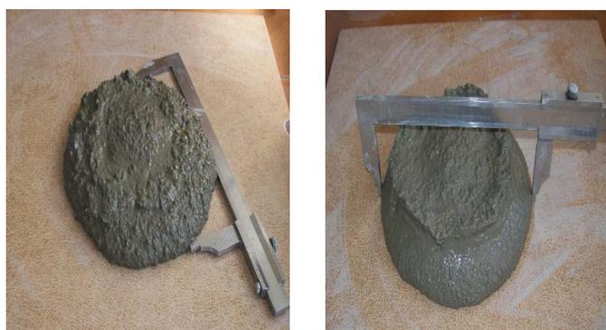
Fig. 4. 21 : Mesure de l'étalement d'un MBE
