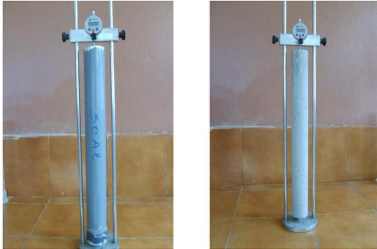
Fig. 5.27 : Exemple de mesure des variations dimensionnelles
