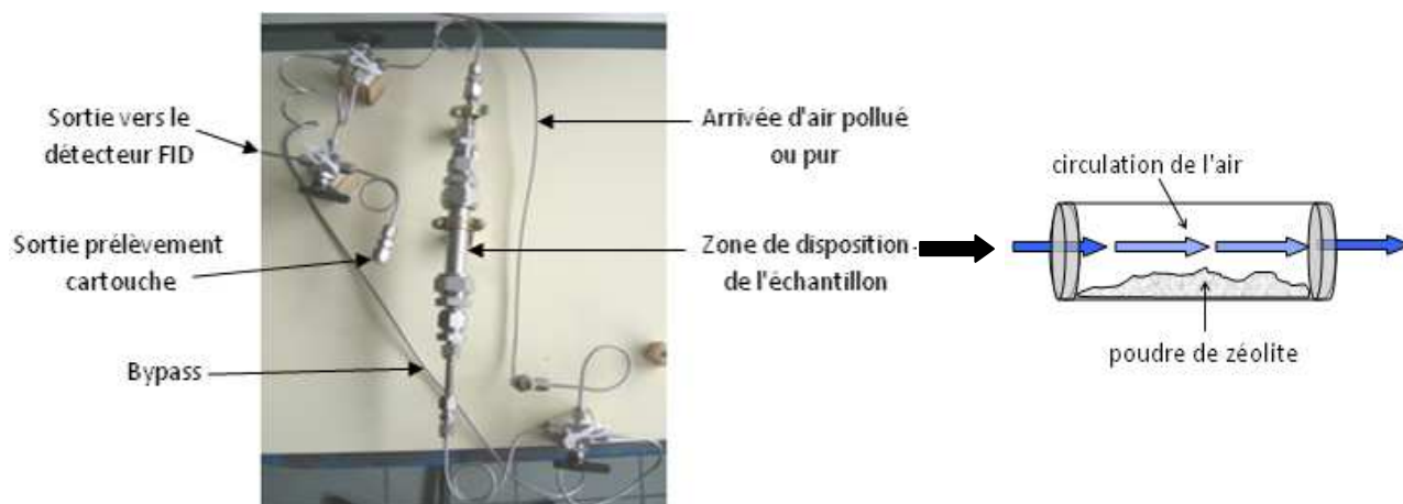
Figure 119: Montage pour l'analyse de l'adsorption de polluants par les zéolites
