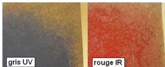
Manque de recouvrement des extrémités des éprouvettes
