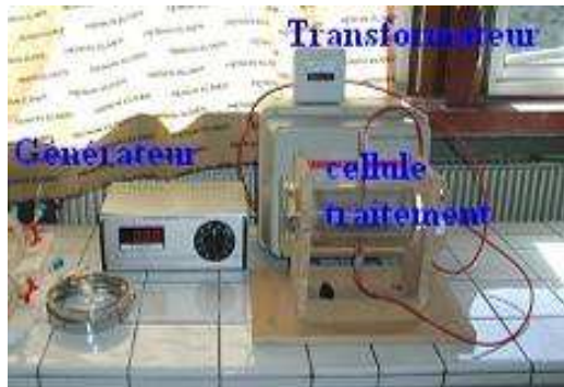
Figure 112: Equipement de traitement Corona du laboratoire et schéma de la cellule de traitement
