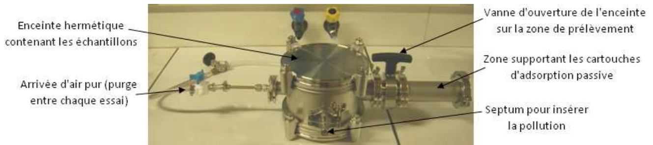
Figure 120: Montage d'analyse de la dépollution de l'air par les finitions recouvertes d'adsorbant
