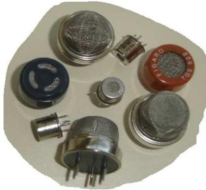
Figure II-1. Exemples de capteurs à oxydes métalliques commerciaux
