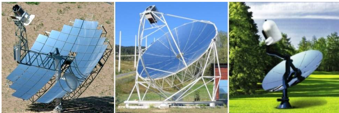
Figure 1.15 : Quelques systèmes Parabole-Stirling de seconde génération (de gauche à droite) : SunCatcher (SES) ; Eurodish (SBP) ; Sunmachine Solar (Sunmachine)
