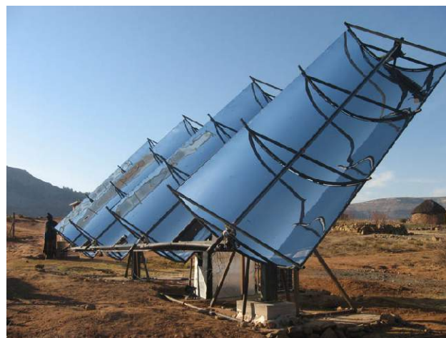
Figure 2.6 : Capteurs CP installés par l'ONG Solar Turbine Group International dans le village de Ha Teboho (Lesotho) essentiellement pour la production d'eau chaude, permettant d'éviter la combustion de bois. Le cogénérateur à turbine ORC génère quelques 600W d'électricité pour 20kW thermiques. Un maximum d'éléments sont issus de récupération. (STG International)
