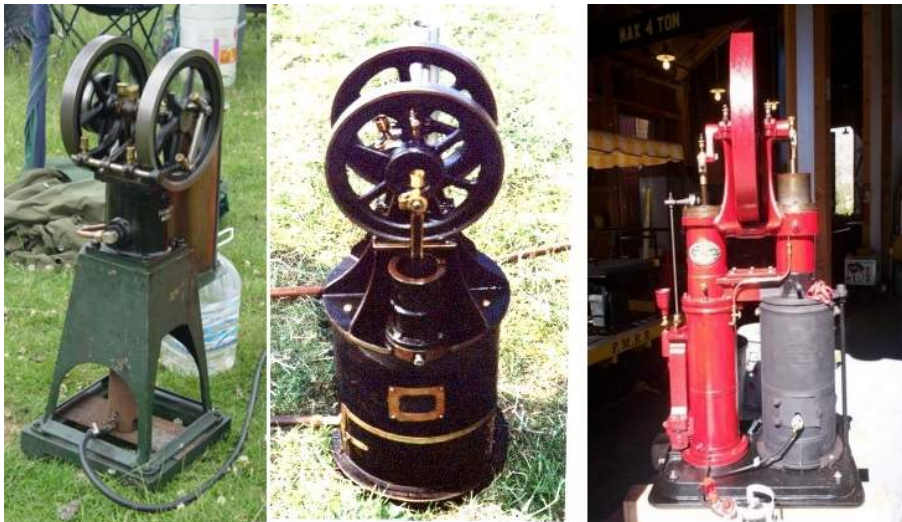
Figure 1.7 : Quelques moteurs de Stirling anciens. De gauche à droite : Moteur Louis Heinrici "universel" (Allemagne, fin XIX e début XX e ) dont la gamme s'étendait d'un diamètre de cylindre 26mm à 190mm, ce type de moteur fut commercialisé jusqu'en 1941. Un petit moteur Heinrici conçu pour animer un piano mécanique. Une pompe à eau "Rider" fabriquée par Ericsson en 1880.
