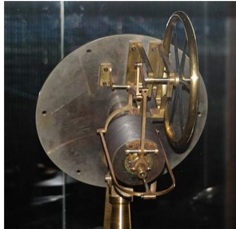
Figure 1.10 : Photographie du premier "dish-Stirling" réalisé par Ericsson. On sait aujourd'hui que le miroir parabolique était largement sous-dimensionné. (John Ericsson Society, New York)
