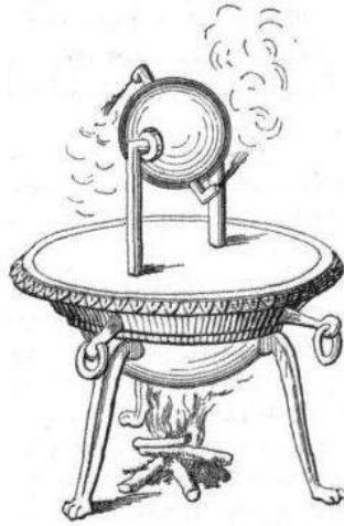
Figure 1.2 : L'éolypile décrite par Héron.
