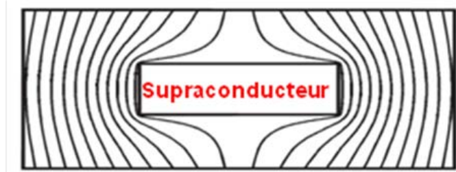
Figure 4.20. Effet d'écran obtenu avec une pastille supraconductrice refroidie hors champ.
