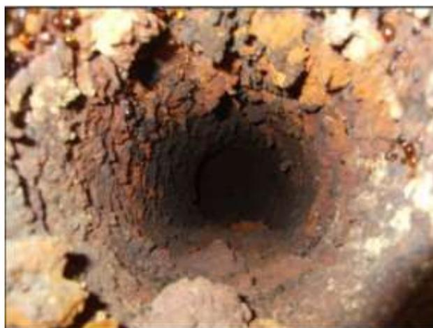
La corrosion et le colmatage observés sur cette conduite s'expliquent par la nature des roches aquifères qui influencent la qualité des eaux. L'aquifère des Grès Vosgien induit une eau très douce et très peu minéralisée, ce qui en fait une eau très agressive et provoque des conséquences sur le vieillissement des réseaux, et une corrosion.
