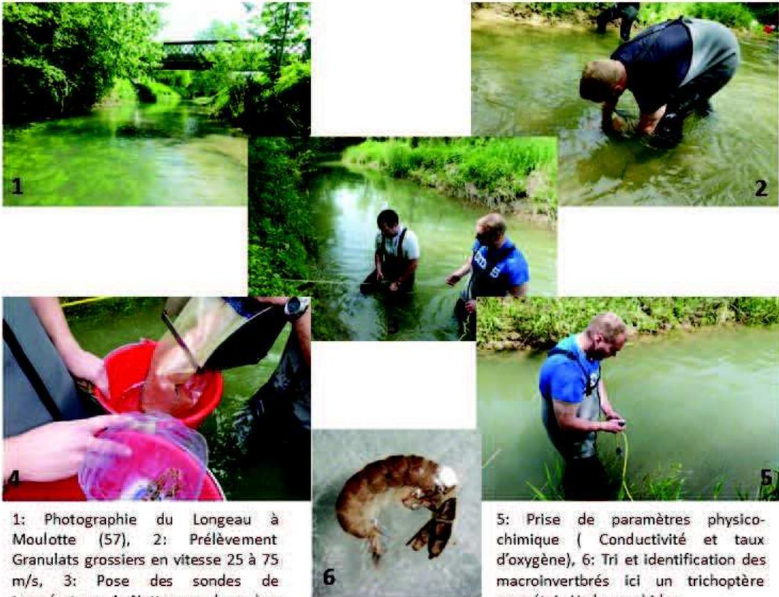
1: Photographie du Longeau à Moulotte (57), 2: Prélèvement Granulats grossiers en vitesse 25 à 75 m/s, 3: Pose des sondes de température, 4: Nettoyage du surber pour récupérer les macroinvertbérés prélevé,
