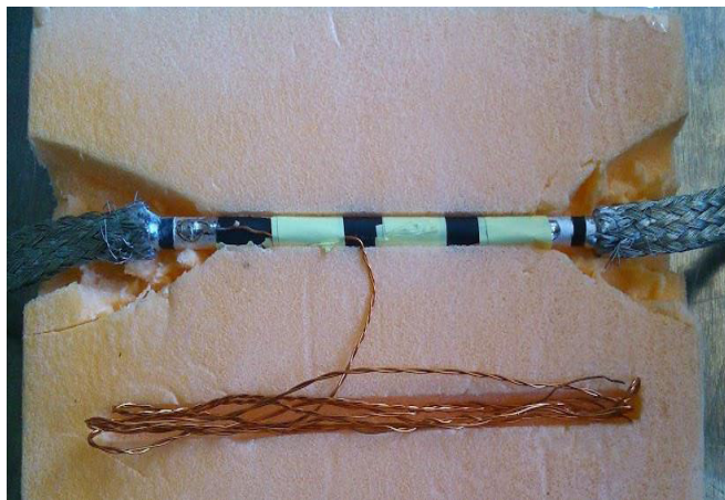
figure I.3.4 le tube supraconducteur
