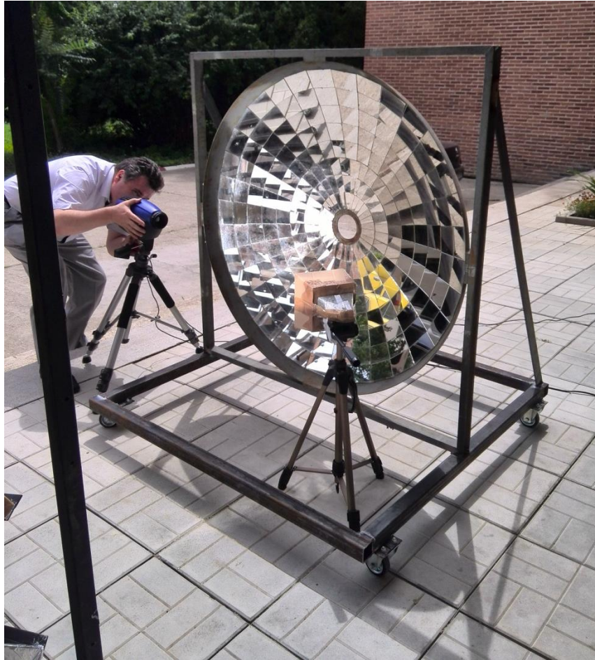
Installation de la caméra pour la prise de température.
