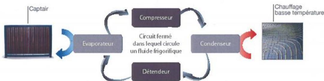
Figure 10 : Schéma de principe P.A.C. capteur à air statique
