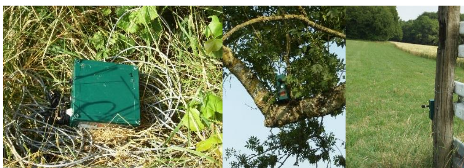
Figure 4 : Exemples de localisation de boîtiers SM2bat pour l'échantillonnage des chiroptères (Photo de terrain 2013, © Caroline Rolland)
