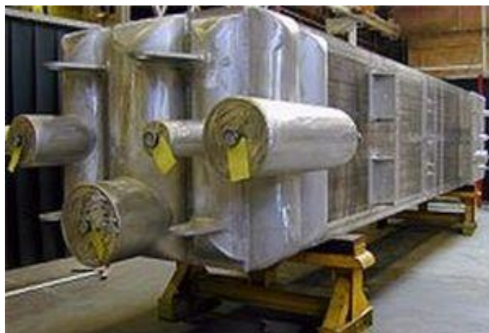
Figure 1 : Fabrication d'échangeur de chaleur en aluminium chez Fives Cryogénie
