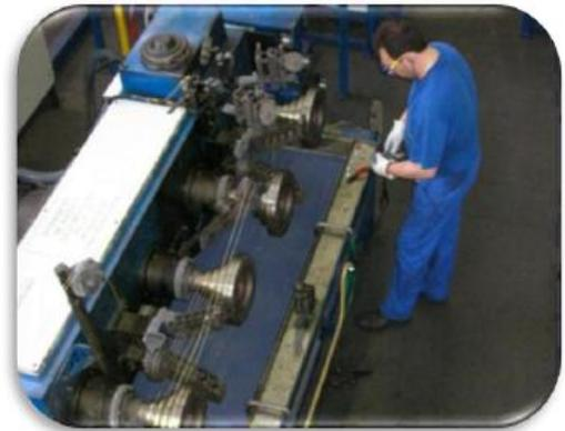
Un deuxième tréfilage, cette fois-ci humide, va encore réduire son diamètre. Le fil va alors être assemblé de différentes façons (**phase 6**) selon le type de pneu dans lequel il va être utilisé. On aura alors un câble avec les propriétés voulues assurant la résistance mécanique du pneu.
