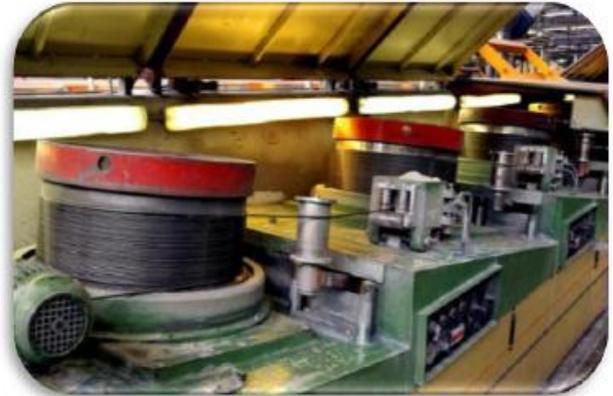
A partir de cette opération de tréfilage à sec, le fil va servir, soit pour la création de tringles soit pour la fabrication de câbles.
