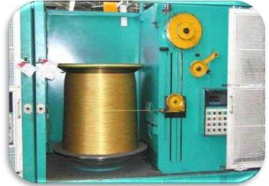
Ensuite, par hydrolyse de cuivre et de zinc, un alliage de laiton va se former autour du fil le protégeant de la corrosion.
