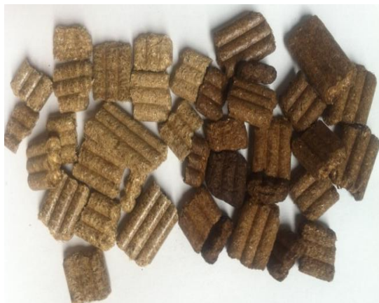
Figure 31 : Granulés de paille avant et après torréfaction
