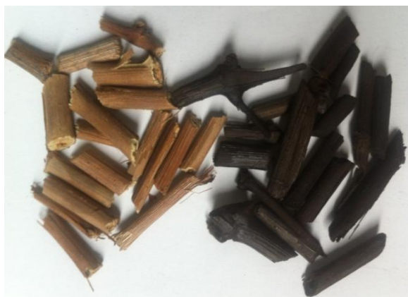
Figure 32 : Sarments de vigne avant et après torréfaction
