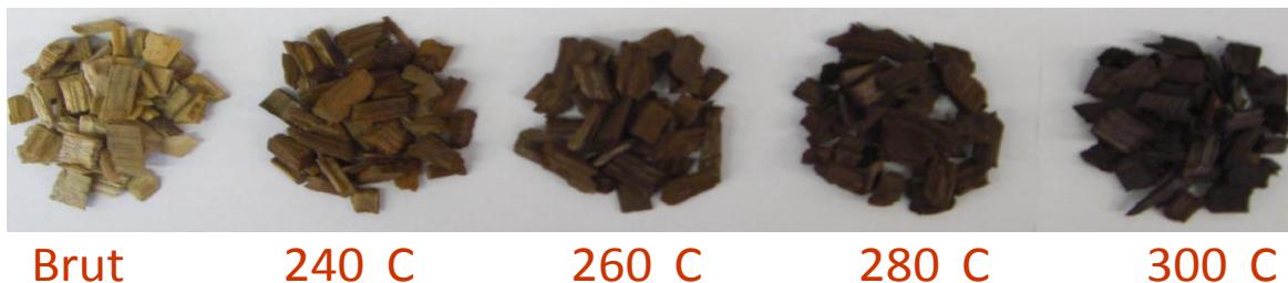
Figure 3 : Photo de pin torrifié à différentes températures
