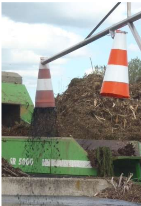
Figure 14 : Pulvérisation à Laître sous Amance partiellement bouchée
