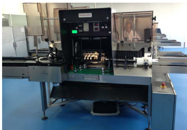
Figure 2 : Equipement de l'atelier de mirage
