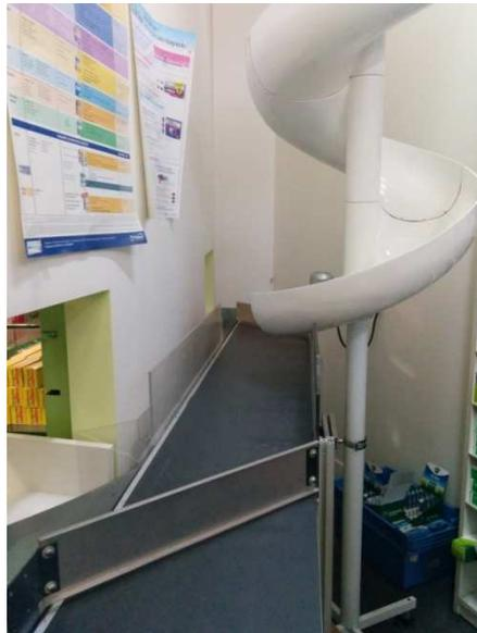
*Figure 16 : Photo du système d'aiguillage de l'automate Pharmax*
