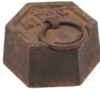
Figure 66 : Etalon hexagonal de kg muni d'un anneau.
