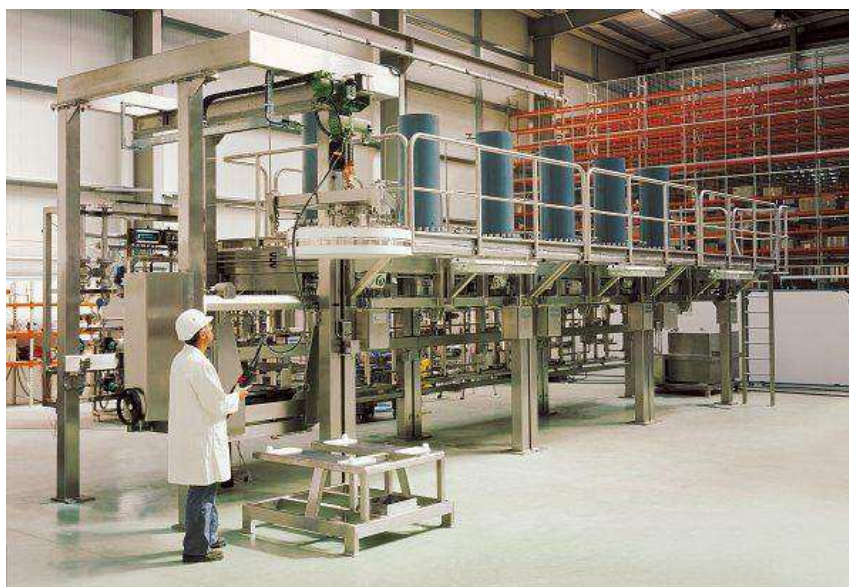
Figure 38 : Installation industrielle de système Varicol® 6-1000 (6 colonnes de 1000 millimètres de diamètres) utilisée par AMPAC Fine Chemicals pour la fabrication d'un principe actif pharmaceutique dans son usine proche de Sacramento (Etats-Unis)
