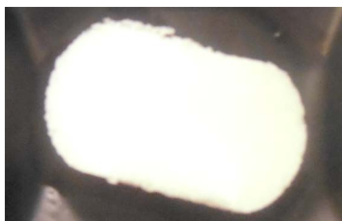
Figure 68 : Comprimé de glucose déformé après test brésilien
