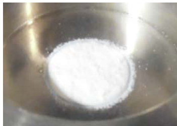
Figure 44 : Exemple de comprimé collé au fond de la matrice
