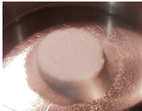
Figure 63 : Comprimé contenant uniquement des billes sans tenue
