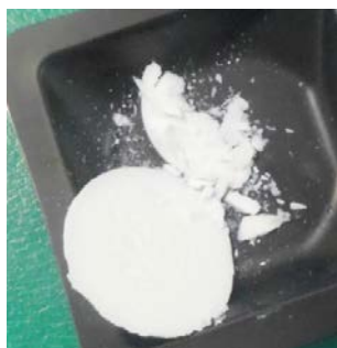
Figure 49 : Comprimé clivé en 2 : une lamelle fine et des résidus de compact
