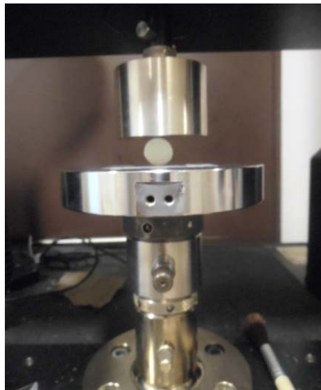
Figure 21 : Montage du test brésilien
