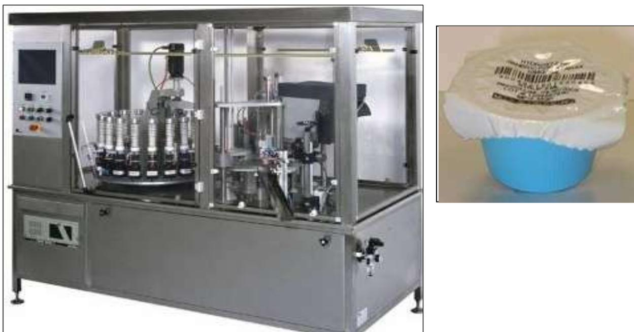
**Figure 18 : Automate de PDA de formes buvables avec un gobelet nominatif.**
