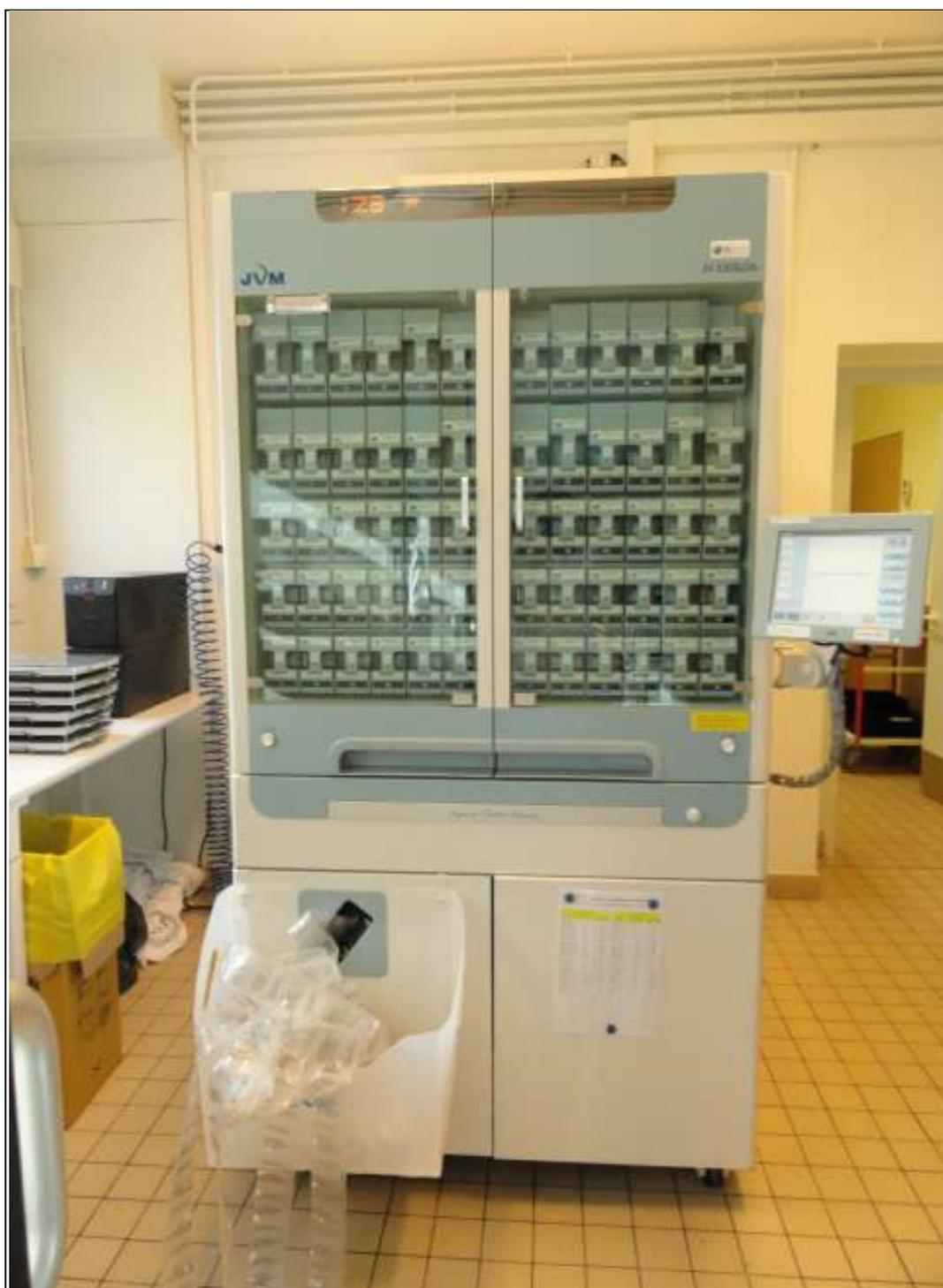
**Figure 7 : Automate Sygiph® du laboratoire Euraf®.**
