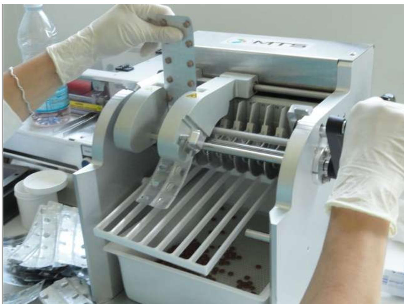
**Figure 9 : Déconditionnement semi-manuel de comprimés.**
