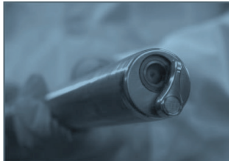
Figure 13 : Détail du dispositif de désencrassement d'une sonde FBRM ® .
