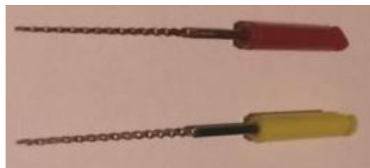
Figure 28 : Photo des broches MICRO-MEGA® en CuAlBe monocristallin (au-dessus) et NiTi polycristallin (en dessous)
