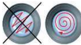
Figure 82 : Mouvement correct en spirale pour le nettoyage des surfaces optiques du microscope (Source : www.cdc.gov ).
