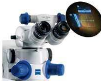
Figure 28 : Croix de visée gravée dans l'objectif ici dans le microscope de la marque ZEISS® (Source : brochure ZEISS®).
