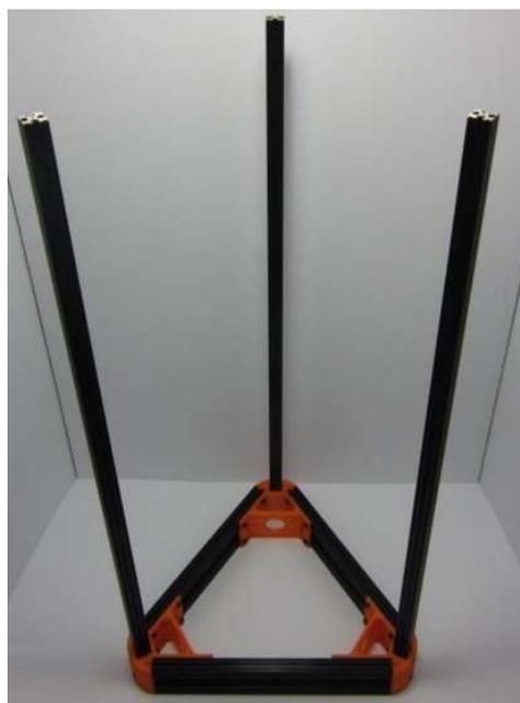
**Figure 106** : Assemblage du châssis (Source : blonker industries)
