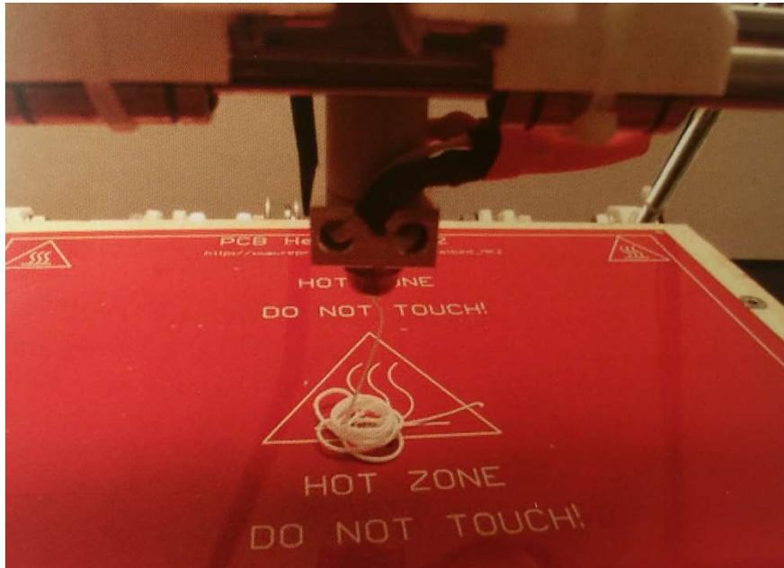
**Figure 167** : Extrusion du filament préparatoire (Source : L'impression 3D 2<sup>ème</sup> édition)
