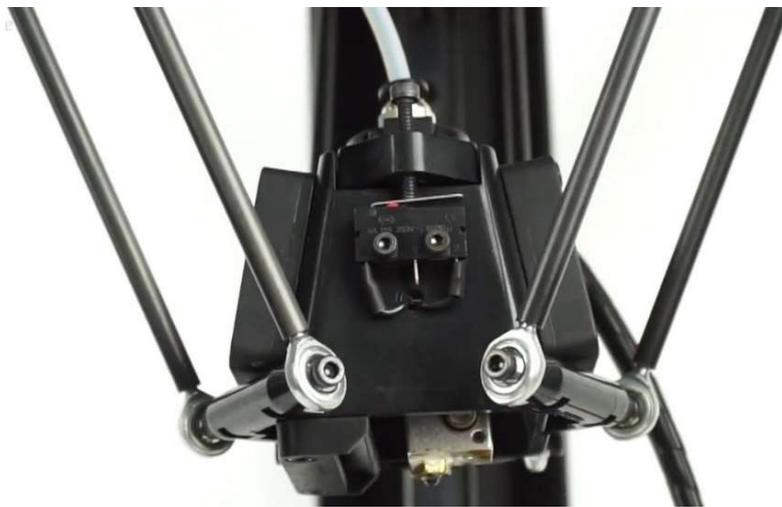
**Figure 132** : Disposition d'auto calibration par la buse d'extrusion montée sur pivot avec un *endstop*
