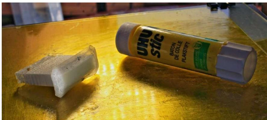
**Figure 137** : Utilisation de colle en bâton *UHU*<sup>®</sup> comme adhésif (Source : tridimake)
