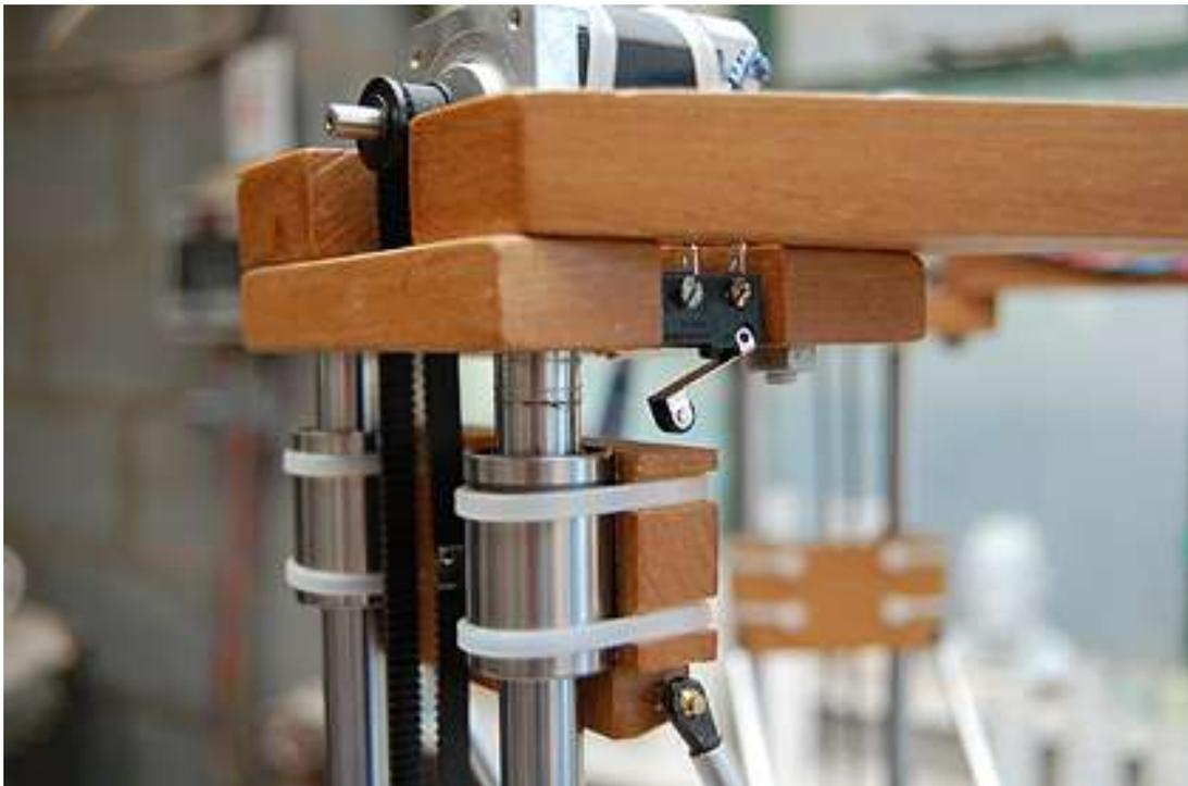
**Figure 86** : *Endstop* mécanique en position ouvert en bout d'axe z d'une imprimante 3D delta
