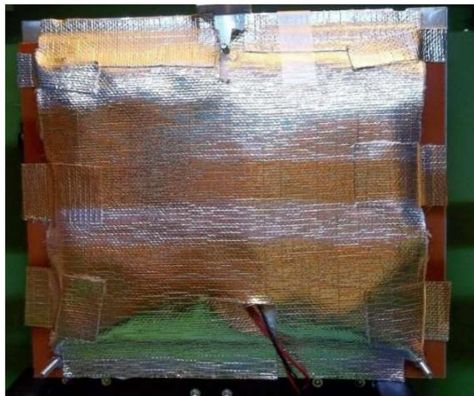
**Figure 128** : Isolation du lit chauffant avec du scotch aluminium (Source : craftunique)
