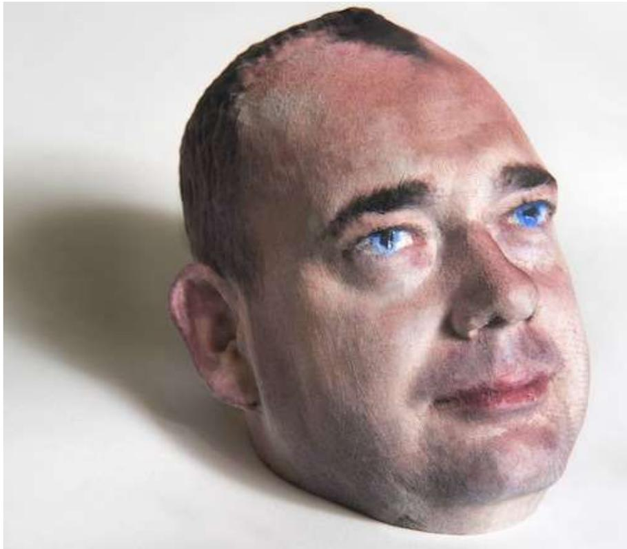
**Figure 72** : Tête en couleurs réalisé par une imprimante 3D LOM modèle *Iris* de chez *Mcor Technologies*<sup>TM</sup> (Source : mcor technologies)
