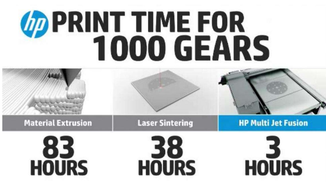
**Figure 63** : Comparatif du temps de production de 1000 engrenages par trois procédés différents, la fusion déposition de matériau FDM, la fusion laser SLS et la technologie *Multi Jet Fusion*<sup>®</sup> (Source : references3d)
