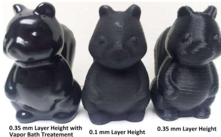
**Figure 69** : Comparaison de l'état de surface de trois figurines imprimées par la technique FDM avec des réglages différents. De gauche à droite, couche de 0.35mm avec polissage à l'acétone, 0.1mm sans polissage, 0.35mm sans polissage (Source : 3ders)
