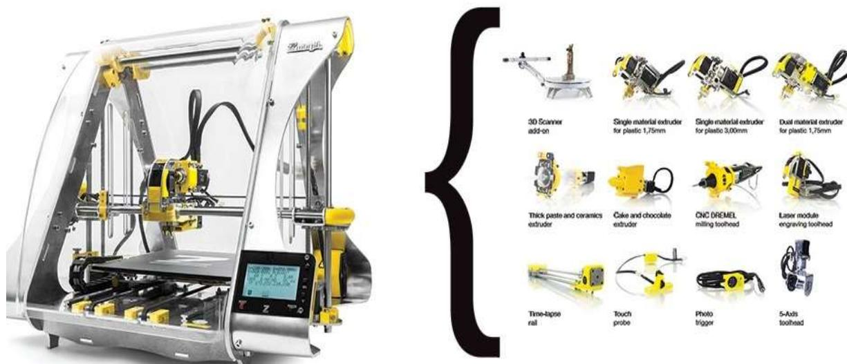
**Figure 134** : Imprimante 3D FDM *Zmorph*<sup>®</sup> 2.0 à gauche, avec têtes interchangeables à droite (Source : zmorph)
