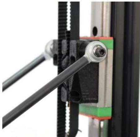
**Figure 101** : Entraînement par courroie des chariots (Source : loneshopper)
