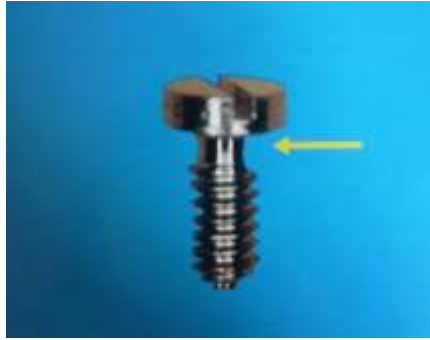
Figure 150 : rétrécissement sous la tête de vis: zone de fragilité.
