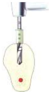
Figure 27 : butée placée sur le foret.
