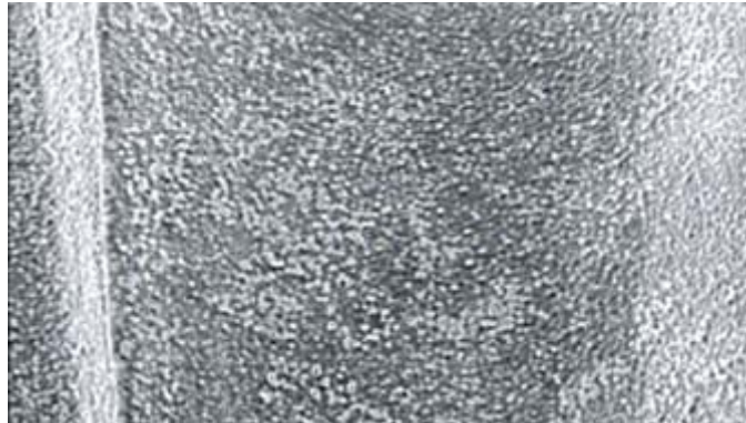
Figure 22 : Surface obtenue par oxydation anodique (Davarpanah et coll., 2008)
