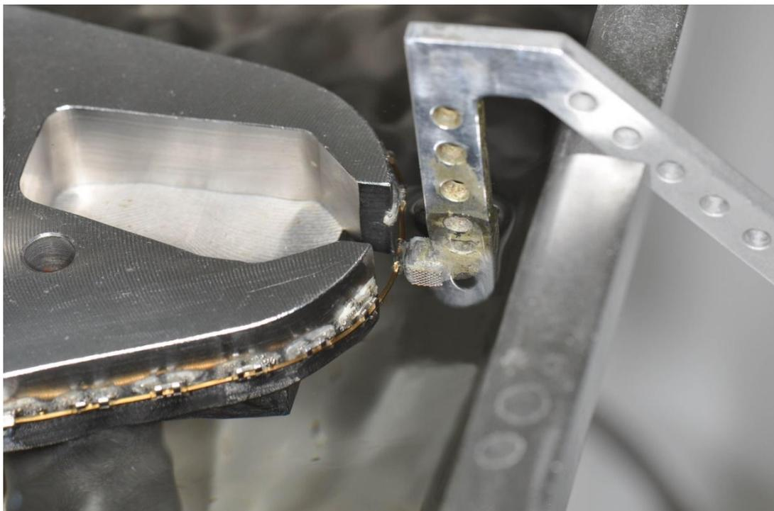
**Figure 12- Transmission du moment de torsion à l'arc par le levier (illustration personnelle)**
