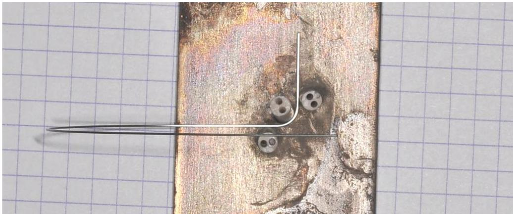
**Figure 8 - Angle imposé au fil orthodontique par le banc de conformation (illustration personnelle)**
