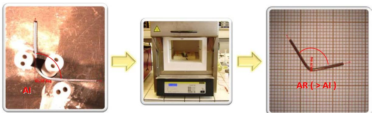
Figure 16 - A l'issue du traitement thermique, l'angle résiduel conservé par le fil est plus ouvert que l'angle imposé par le banc de conformation (illustration personnelle)
