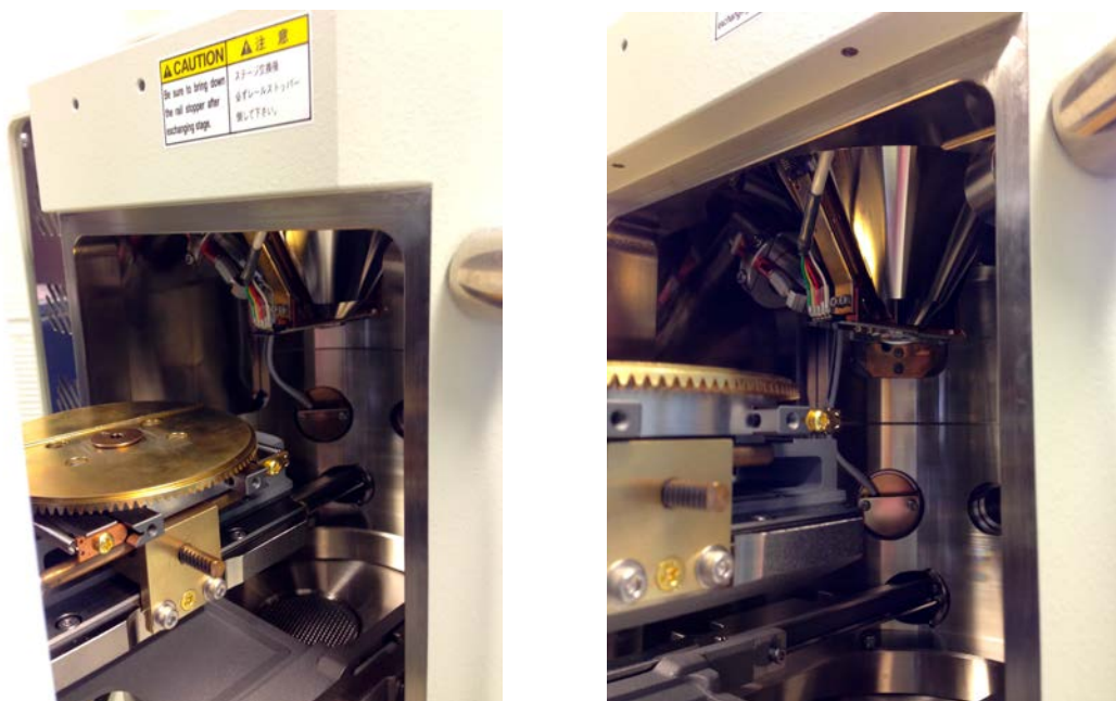
Figure 13 : Intérieur du MEB (vue de la platine circulaire où sont déposés les échantillons à gauche, et émetteur à droite)
