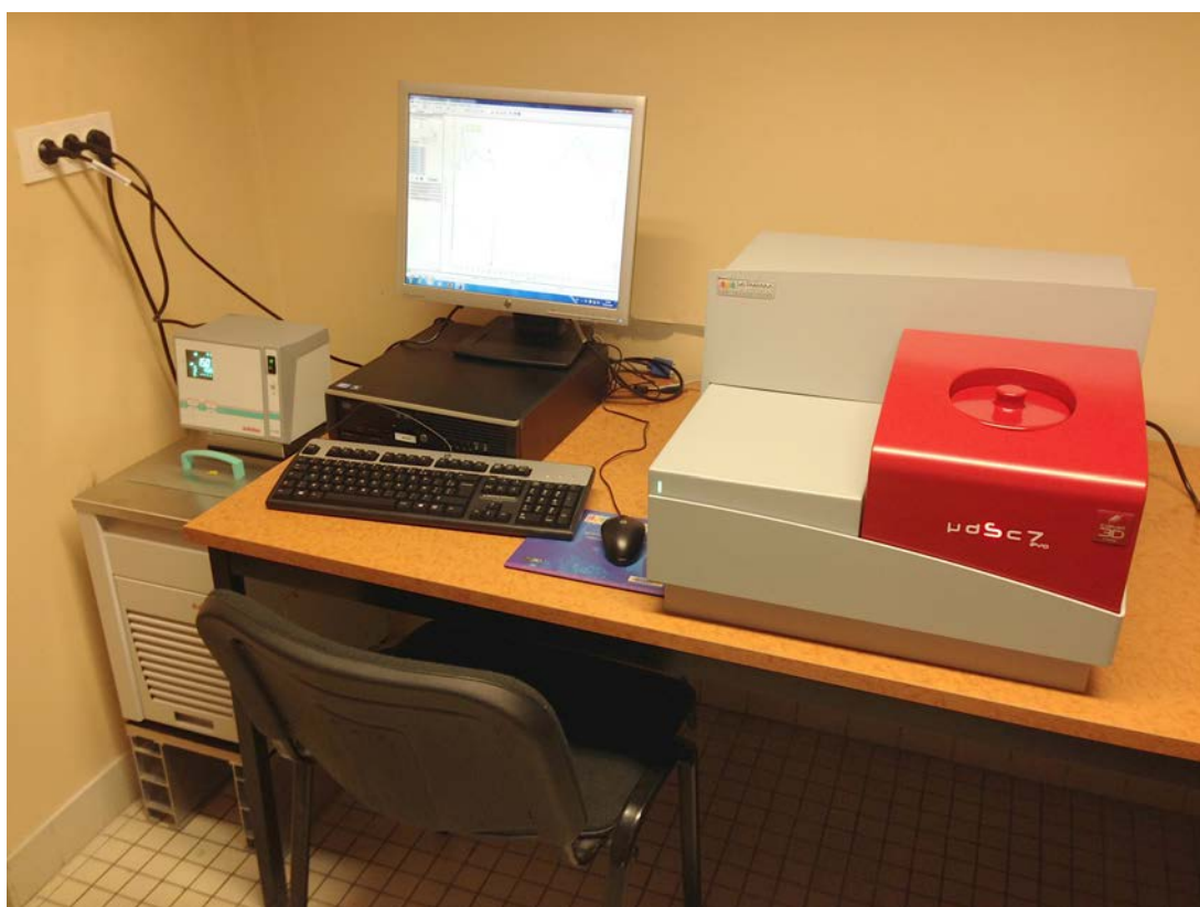
Figure 14 : Circuit d'eau servant à la régulation de la température à gauche, ordinateur analysant les données, et \mu DSC7 evo (SETARAM) à droite
