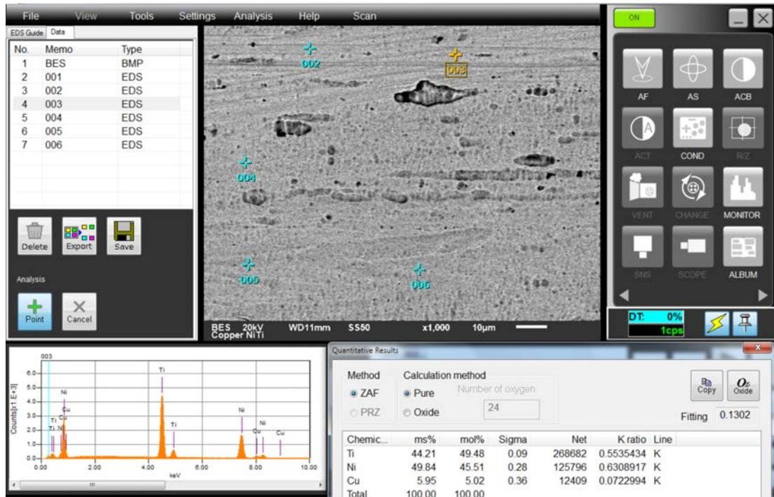
Figure 29 : Détermination de la composition de surface du fil Damon™ observé au MEB (grossissement x1000) - spectre EDS en bas à gauche, composition en bas à droite
