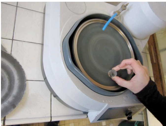
Figure 8 : polissage de l'échantillon.
