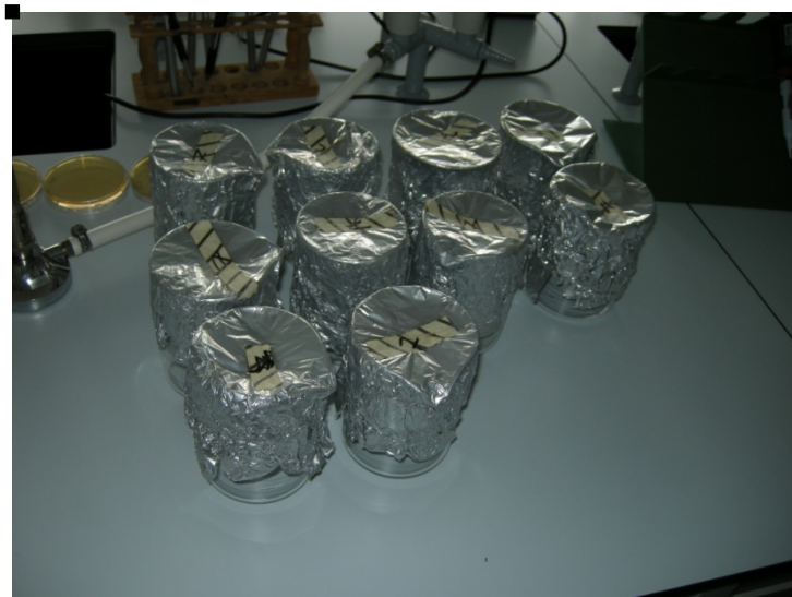
Figure 7 - Dix des vingt bêchers stériles L'aluminium permet de conserver le contenu des bêchers en milieu stérile
