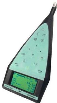
**Figure 19** - Sonomètre intégrateur utilisé pour les mesures sonores lors de cette étude
