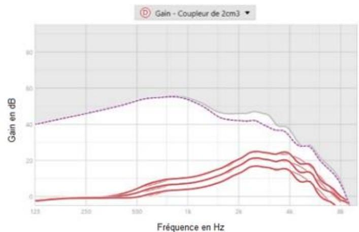
Figure 95 Gain coupleur 2cc de l'appareil utilisé (logiciel)
