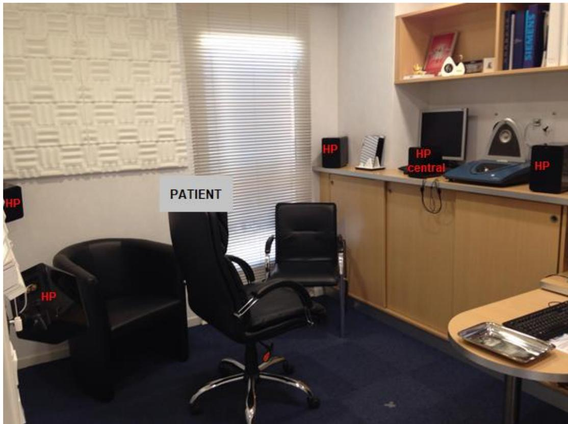
Figure 69 Représentation réelle de la disposition en cabine de test
