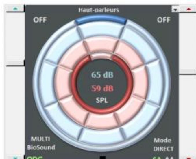
Figure 71 Exemple de configuration pour un RSB de 6 dB SPL. Piste 1, haut-parleur de face à 65 dB SPL. Piste 2, les 4 haut-parleurs latéraux à 59 dB SPL (interface BioSound)
