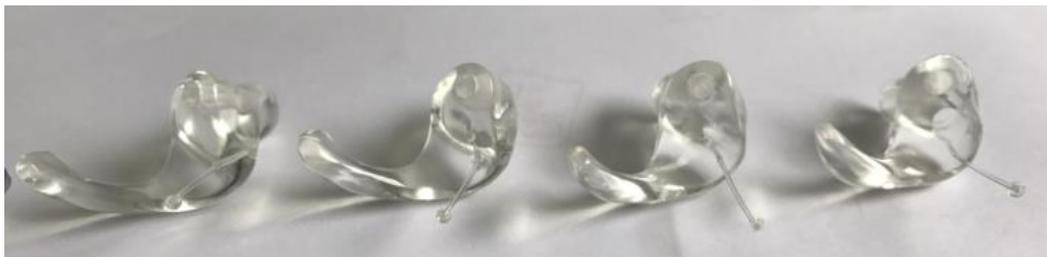
**Figure 87 Les quatre embouts sur-mesure fabriqués pour les mesures sur KEMAR**
