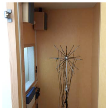
ILLUSTRATION 46: EMBLACEMENT DE L'ANTENNE MICROPHONIQUE DANS LA CABINE AUDIOMETRIQUE
