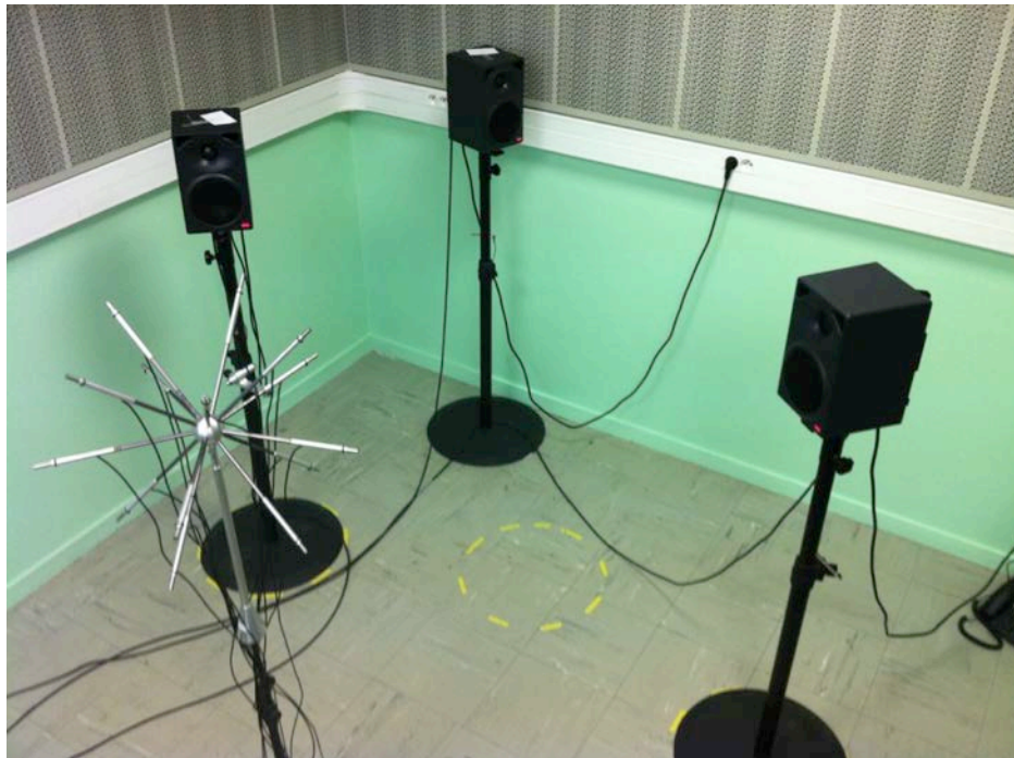
ILLUSTRATION 61: POSITIONNEMENT DE L'ANTENNE MICROPHONIQUE ET DES HAUT-PARLEURS DANS LA SALLE DE STEREOLOCALISATION.
