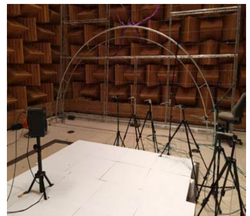
ILLUSTRATION 42: MESURE DE DIRECTIVITE DES HAUT-PARLEURS EN CHAMBRE SEMI-ANECHOÏQUE DE L'INRS
