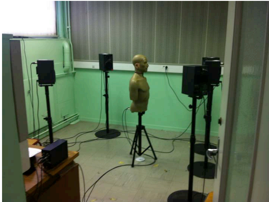
ILLUSTRATION 60: SALLE DE STEREOAUDIOMETRIE. EN FOND KEMAR ENTOURE DES 5 HAUT-PARLEURS DE LA SALLE. SYSTEME D'ACQUISITION EN PREMIER PLAN.
