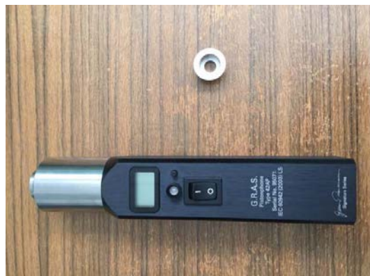
Figure 33 : piston-phone spécifique pour KEMAR et adaptateur
