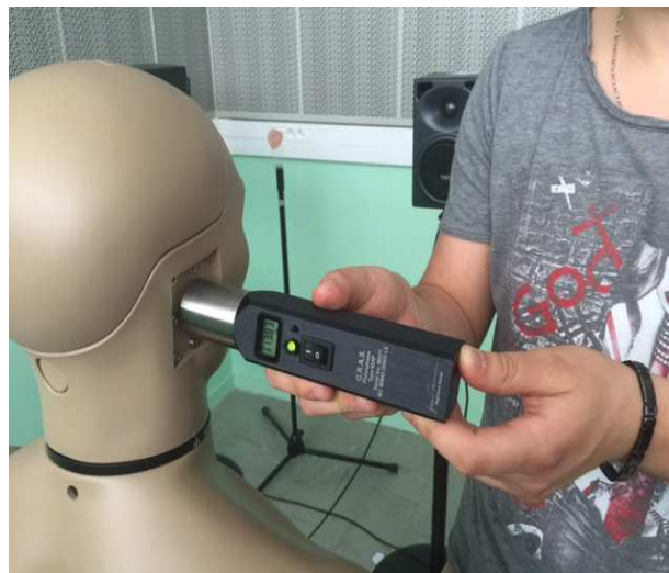
Figure 34 : étape d'étalonnage du KEMAR
