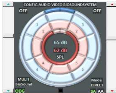
Figure 18 : Configuration des haut-parleurs pour l'audiométrie vocale dans le bruit, BioSoundSystem 3.0
