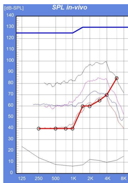
Figure 17 : Courbes de réponse de l'aide auditive dont les réglages sont basés sur l'audiogramme ci-contre
