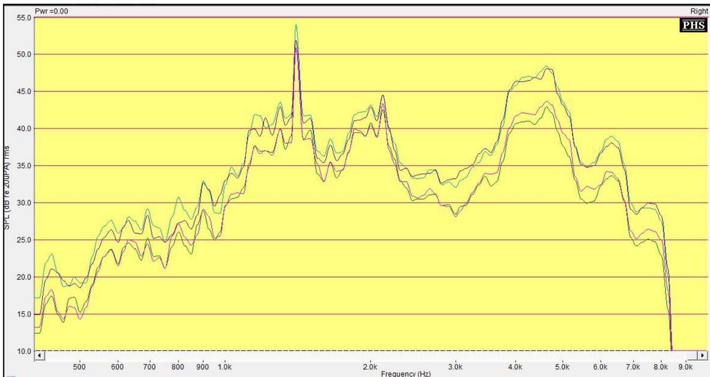
Figure n°67 : Spectres du bruit de rame de métro émis à 40 dB SPL, obtenus avec les programmes P1 (vert), en P2 (bleu), en P3 (violet) et en P4 (rose)
