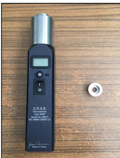
Figure n°13 : Piston Phone et adaptateur
