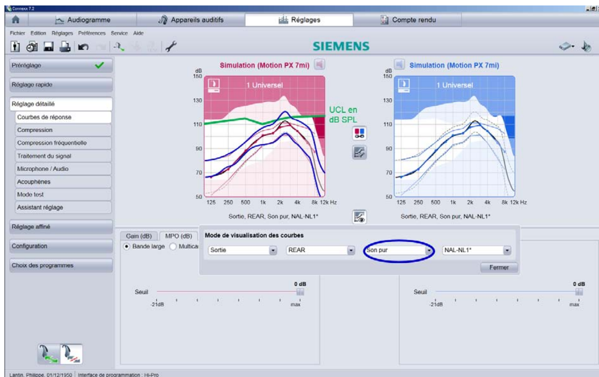
Illustration 32: Capture d'écran d'un réglage de MPO en prenant comme stimulus d'entrée le son pur
