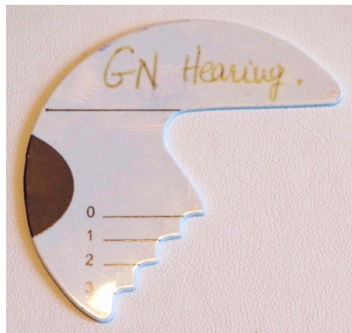
Figure 56 : Outils de mesure pour déterminer de la taille de l'écouteur pour l'Alera 961
