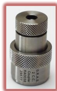
Fig 5 : Coupleur 2cc normalisé IEC 126 et ANSI S3.7-1973 7
