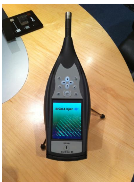
Figure 27 : Sonomètre Brüel & Kjaer de type 2250 light
