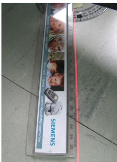
Figure 106 : Alignement du laser avec la règle pour plus de précision
