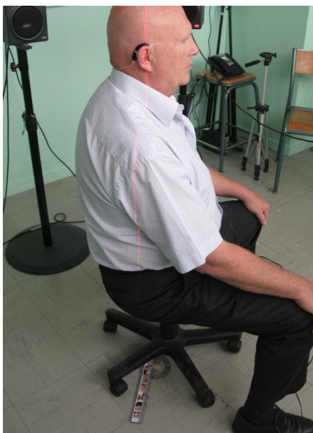
Figures 105 : Alignement du centre des 2 microphones avec le laser
