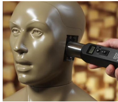
Figure 8 : Calibration du simulateur d'oreille avec un pistonphone [14]
