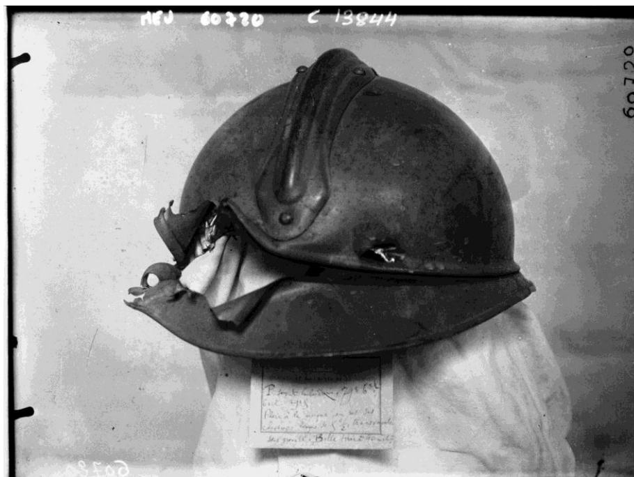
Figure n°47: Photographie d'un casque. Percement important sur un tir à 40 mètres. Photographie Val de Grâce, musée des Archives et matériel du Service de Santé©.
